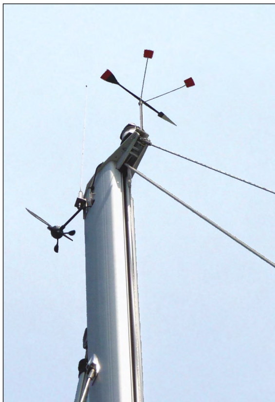
1 - Mostravento in testa d'albero. Comunemente conosciuto anche col nome commerciale di windex .
