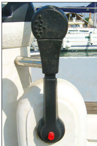
1 - Manetta di una barca da crociera. È in posizione verticale, neutra. N.B. Anche i motori fuoribordo vanno avviati con la marcia in folle.
