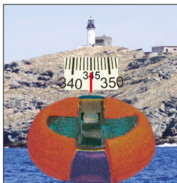
2 - Bussola portatile da rilevamento. Ne esistono di vari tipi. Sono in commercio anche binocoli con bussola incorporata che permette il rilevamento direttamente attraverso l'oculare.
