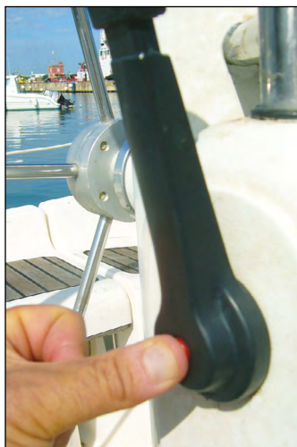
2 - Se premendo il pulsante del folle si riesce a schiacciarlo, la marcia non è inserita, si può quindi avviare il motore.
