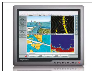
1 - Chart-plotter: schermo multifunzione del Gps cartografico. L'apparecchio può essere interfacciato con altri strumenti quali radar, ecoscandaglio, solcometro, etc. Le sue generose dimensioni permettono la contemporanea visione di differenti schermate.
